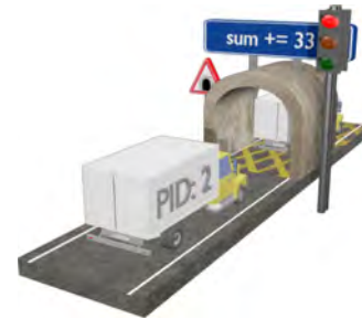
Figura @ Caso de uso de la notación en un contexto de programación concurrente, donde un hilo (camión) intenta acceder a la sección crítica de un programa (franjas diagonales amarillas sobre el asfalto), actualmente accedida por otro hilo y protegida por un semáforo.
