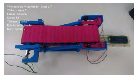
Fig. 3. Ejemplo de uso de la aplicación de realidad aumentada para ayuda a mantenimiento.
