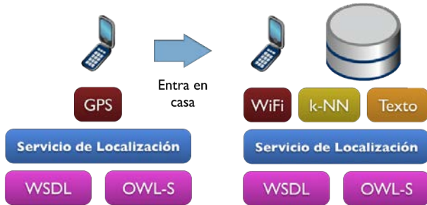
Figure 3: Adaptaciones realizadas tras un paso de exteriores a interiores.
