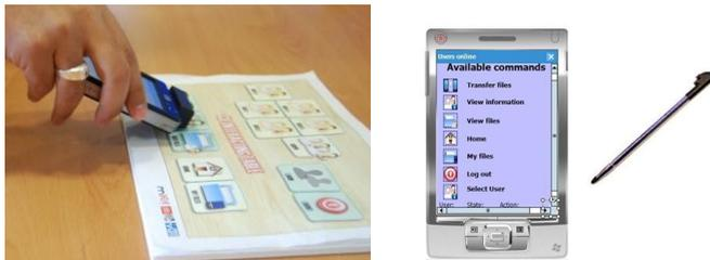
**Fig. 2.** Panel interactivo que integra tecnología RFID y proporciona servicios realizando un gesto natural con la PDA. Dispositivo móvil que incorpora el menú con las funciones propias del sistema, se puede acceder a ellas a través del puntero o de manera táctil.
