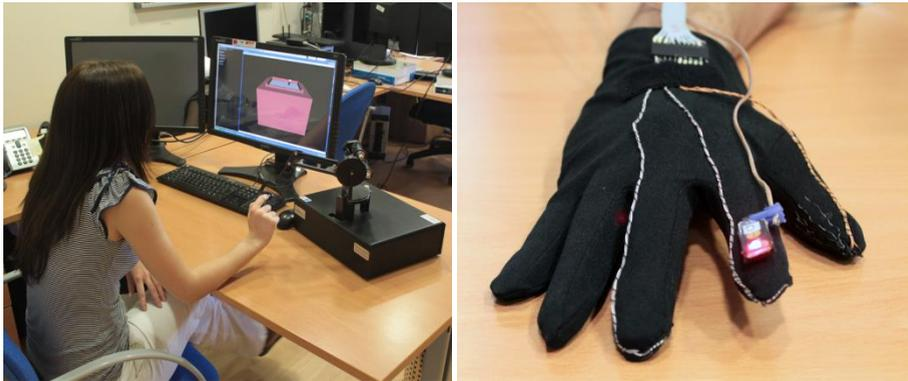
**Fig. 2.** A la izquierda, usuario usando el dispositivo de retorno de fuerzas Phantom. A la derecha, guante de datos con retorno vibrotáctil con un led del sistema de tracking PhaseSpace.
