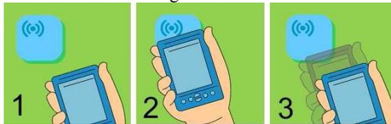
**Fig. 1.** Aproche&remove, técnica de interacción móvil con las tarjetas RFID que se integran en los objetos. Consiste en acercar y alejar el dispositivo móvil al objeto digitalizado.
