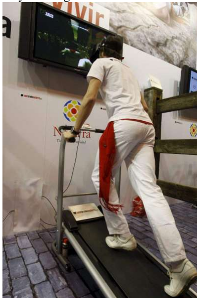
Fig. 2: Simulador virtual formado por una cinta sensorizada y un HMD
