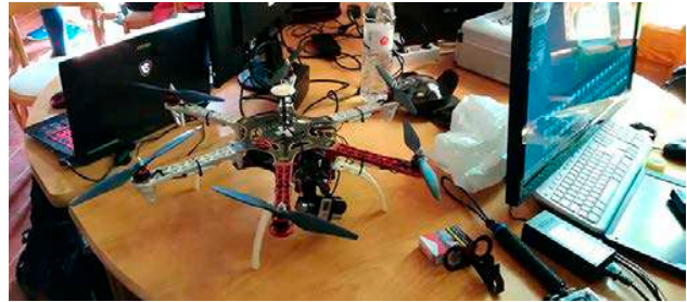
Fig. 2. Dispositivo RPAS de 6 hélices y ordenador procesando las fotografías.
